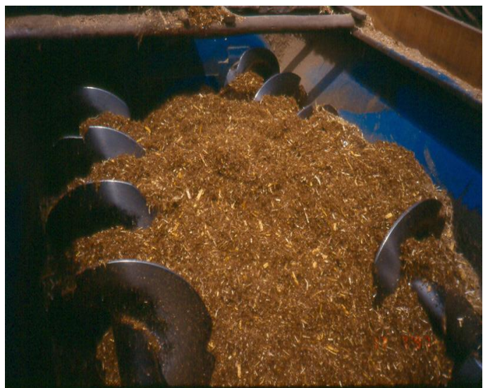
Figura 12. Mezcla de un Alimento balan – ceado de engorde
